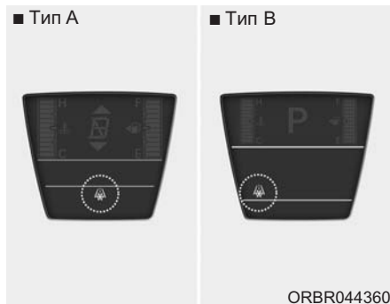
Сигнализатор обледенения дорожного покрытия (при наличии)
